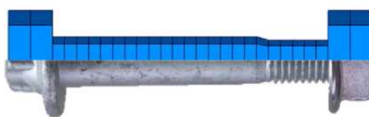
Рис. 9. Модель болта с крупной сеткой в сравнении с реальным болтом
