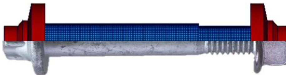
Рис. 5: Модель болта с мелкой сеткой в сравнении с реальным болтом
